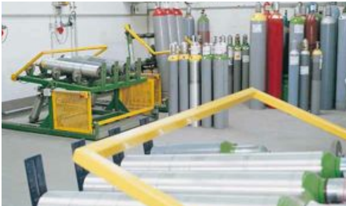
Stations de mélange à rouleaux pour l'homogénéisation de mélanges gazeux réalisés par gravimétrie.
